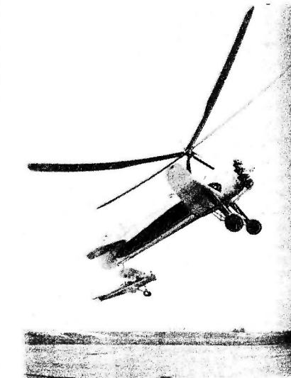
El primer autogiro norteamericano: el ancho de las aspas ha disminuído y cola vuelve a lo normal.
