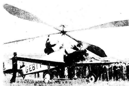
Uno de los primeros modelos construído en Inglaterra: es poco más que un avión corriente, con aspas.
